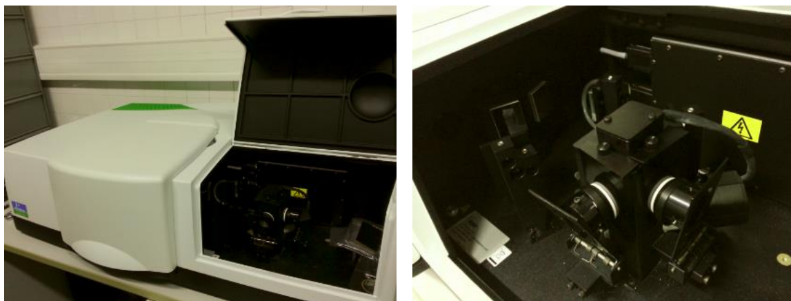
Figure 1 : vues du spectromètre UV-Visible-NIR Perkin-Elmer Lambda 750 ® et de sa sphère intégrante
